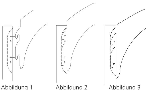
Bei richtiger Montage schließt das Bogenpaneel seitlich mit der Oberkante der Torpfosten ab und ist an beiden Stiften eingehakt. (siehe Abbildung 3).
